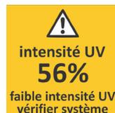
En deçà de 56 %, les chiffres et les avertisseurs s'illuminent en rouge et un signal sonore est donné par le ballast toutes les 15 secondes. En deçà de 51 %, l'écran s'illumine constamment en rouge et un avertisseur sonore constant retentit. Il alterne avec un écran indiquant que « l'eau peut ne pas être sécuritaire à consommer (water may be unsafe for consumption). » Avec le module à solénoïde, le contrôleur désactive l'électrovanne, et coupe l'écoulement d'eau.
