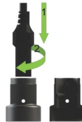
**Figure 10. Connecteur LUMI-Loc™**
