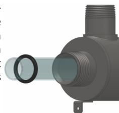
**Figure 4. Installation de la gaine de quartz**
