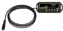
**MODULE ALARME À DISTANCE** : Permet à un signal, via une paire de contacts, d'être connecté à un moniteur à distance tel qu'un avertisseur sonore, d'éclairage, système d'alarme, PLC, etc. Raccordez les contacts OK et COM en fonctionnement normal, et dans une condition d'erreur (Baisse d'UV, défaillance de la lampe, perte de pouvoir), les contacts FAULT et COM seront connectés. La valeur nominale maximale des contacts est de 30 V/1 A (utilisez du fil de calibre 16 à 22).
