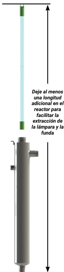
Figura 2. Espaciado para retirar la lámpara
