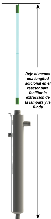
Figura 2. Espaciado para retirar la lámpara
