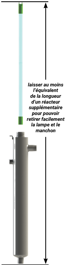
Figure 2. Espace requis pour pouvoir retirer la lampe
