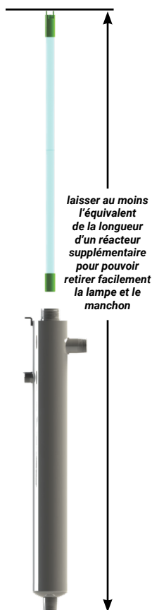
Figure 2. Espace requis pour pouvoir retirer la lampe
